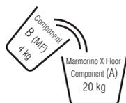
**Пропорции смешивания** 20 кг MARMORINO X FLOOR MEDIUM (component A) + 4 кг Component B (MF)
